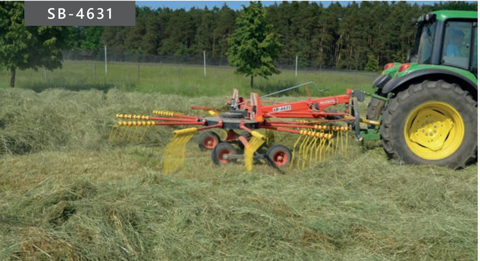
Largeur de travail 4,60 m. TChâssis tandem à quatre roues.
