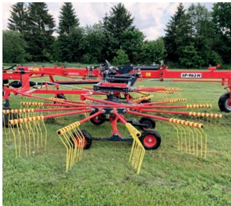
Rotors à 13 bras d'un diamètre de 4,2 m, 4 dents doubles par bras.
