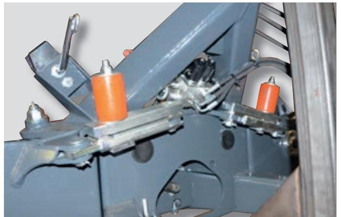
**Distributeur électrohydraulique** permettant de commander indépendamment les deux barres de coupe depuis la cabine du tracteur.
