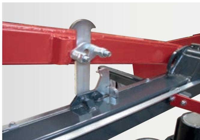
**Relevez le limiteur** et le frein pour éviter l'oscillation de la barre de coupe. Si le limiteur est en position maximale, la faucheuse n'est pas correctement réglée.
