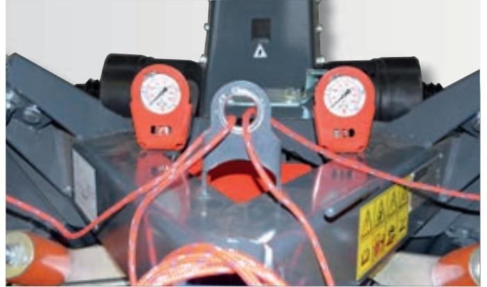
**Le système de déclenchement hydro-pneumatique** de la barre de coupe est un équipement standard.
