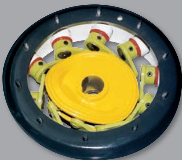
Le mécanisme de l'arbre à cames du rotor est placé dans une boîte fermée remplie d'huile. Le bain d'huile permanent assure un fonctionnement silencieux de la machine et un faible taux d'usure de ses composants.
