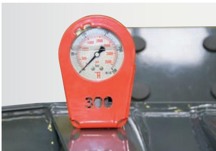
**Mouimètre** pour un contrôle facile et un réglage rapide de la position de flottaison des faucheuses latérales à suspension centrale.
