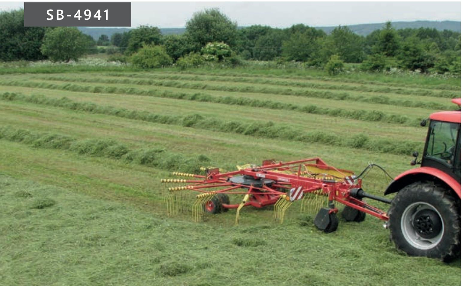
Largeur de travail 4,90 m. Machines traînées, montage double en standard.
