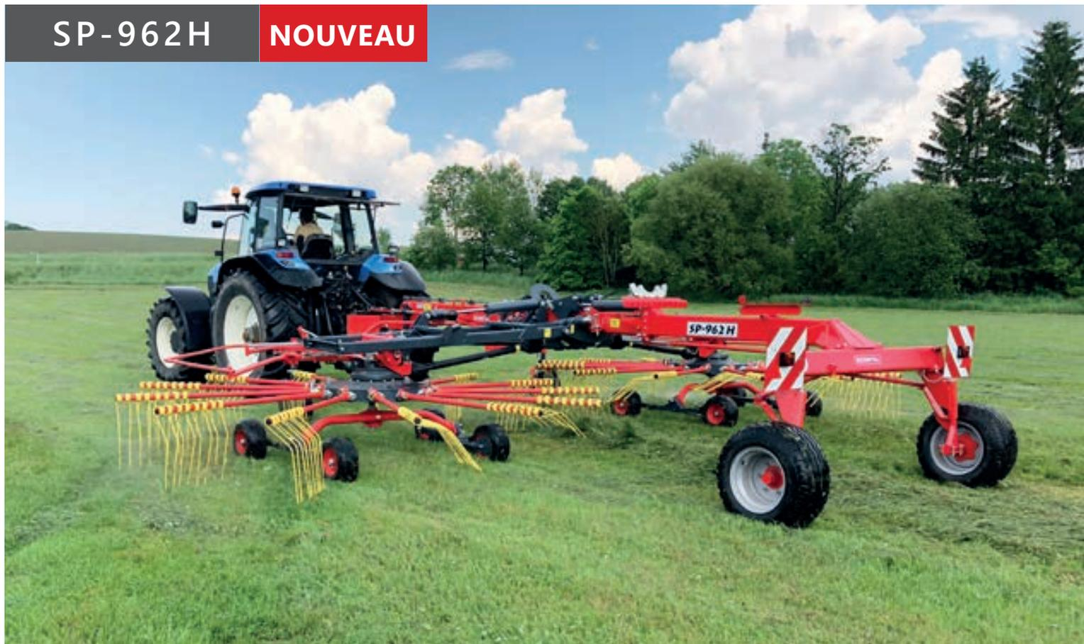
**SP-962H** andaineur à deux rotors avec refoulement au mi-rangeé et largeur de travail réglable en continu par voie hydraulique.
