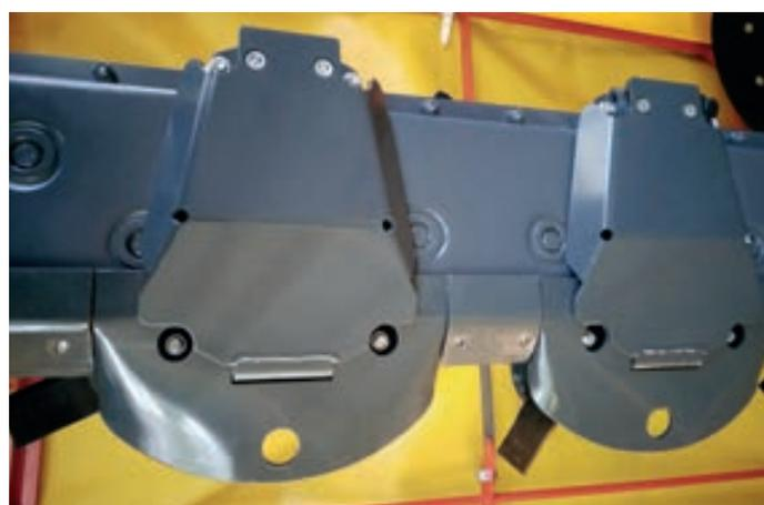
**Les semelles supplémentaires +20 et +50** sont un accessoire optionnel pour toutes les faucheuses ROZMITAL avec suspension centrale et comme les semelles de base sont fabriquées en hardox.
