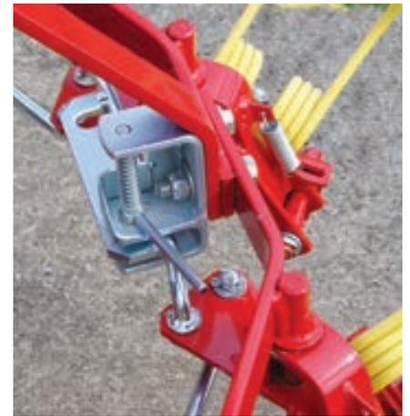
Pour le fanage et le ratissage, il est nécessaire de remettre les bras portedents dans des positions différentes. Le passage d'une position à l'autre est simple et s'applique à tous les bras portedents de chaque rotor simultanément, en une seule opération.
