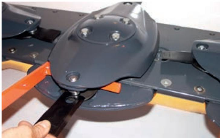
**La dépose rapide** de la lame de la faucheuse à l'aide d'un ressort est standard pour les faucheuses ROZMITAL avec suspension centrale.
