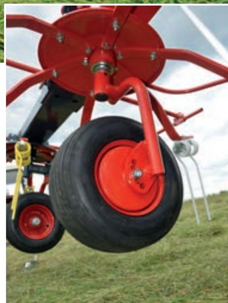
Les roues de jauge peuvent être contrôlées hydrauliquement depuis la cabine du tracteur pour un fanage correct en bout de champ.
