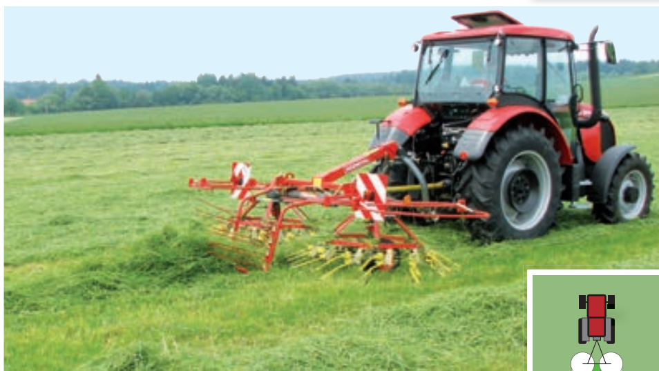
Shrnování - prutové stěny jsou v pracovní poloze
