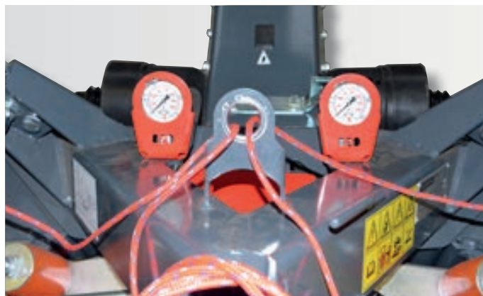
Hydropneumatické nadlehčování je součástí standardního vybavení.
