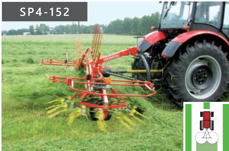
Obracení - prutové stěny jsou v transportní poloze
