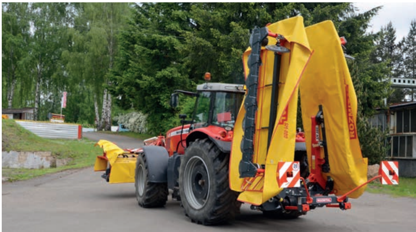
Elektrohydraulickým rozváděčem lze jednotlivě ovládat obě lišty z kabiny traktoru.
