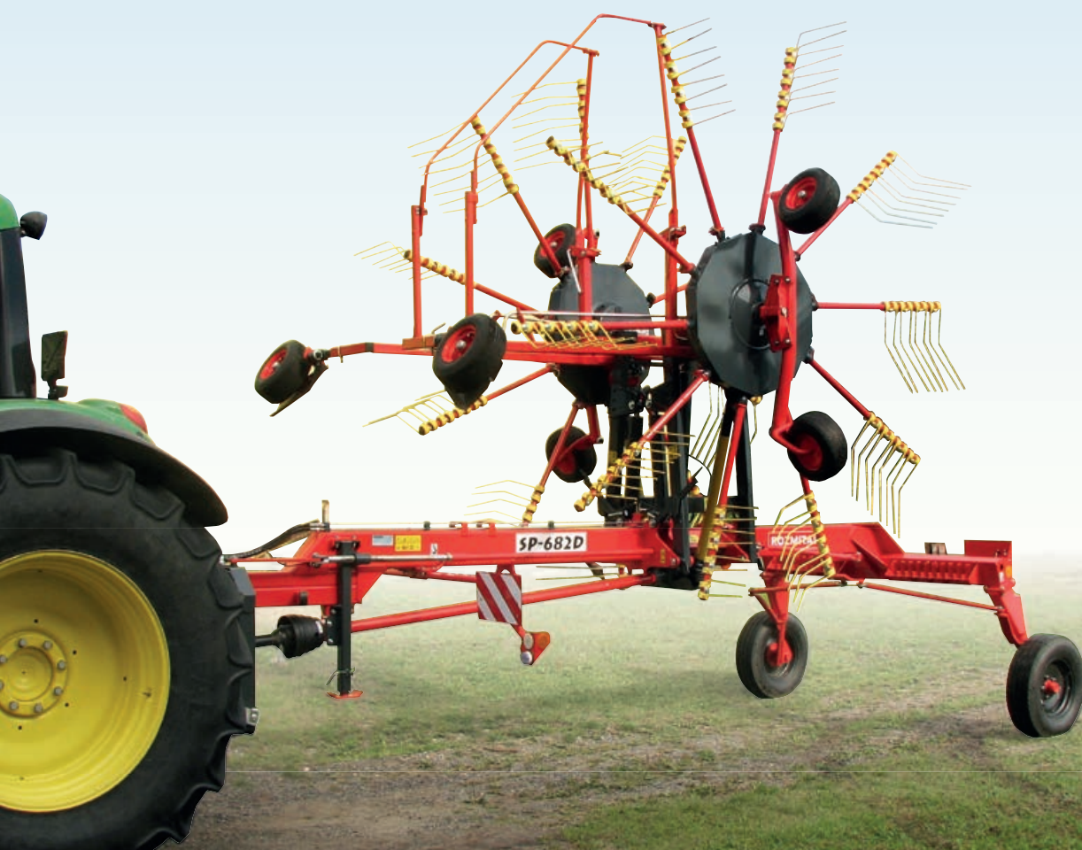
SP - 682D dvourotorový shrnovač na prostřední řádek s pevným pracovním záběrem
