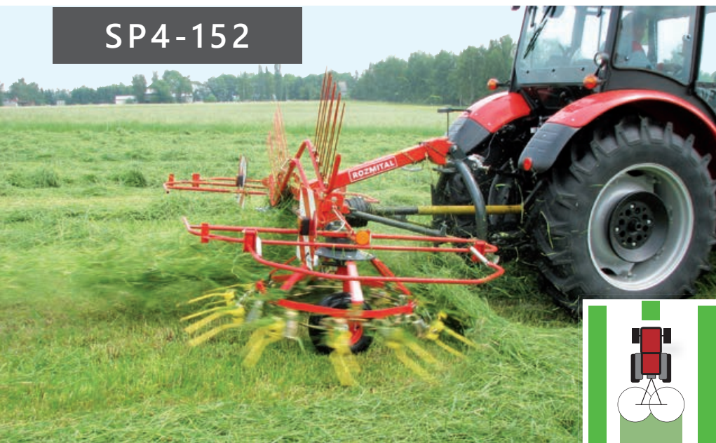
Obracení - prutové stěny jsou v transportní poloze
