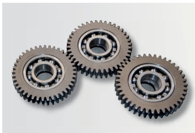
Ozubená kola lišty jsou vykovaná z ušlechtilé oceli a boky zubů jsou broušené. Šířka zubů je 22 mm u všech sekaček Rožmitál.
