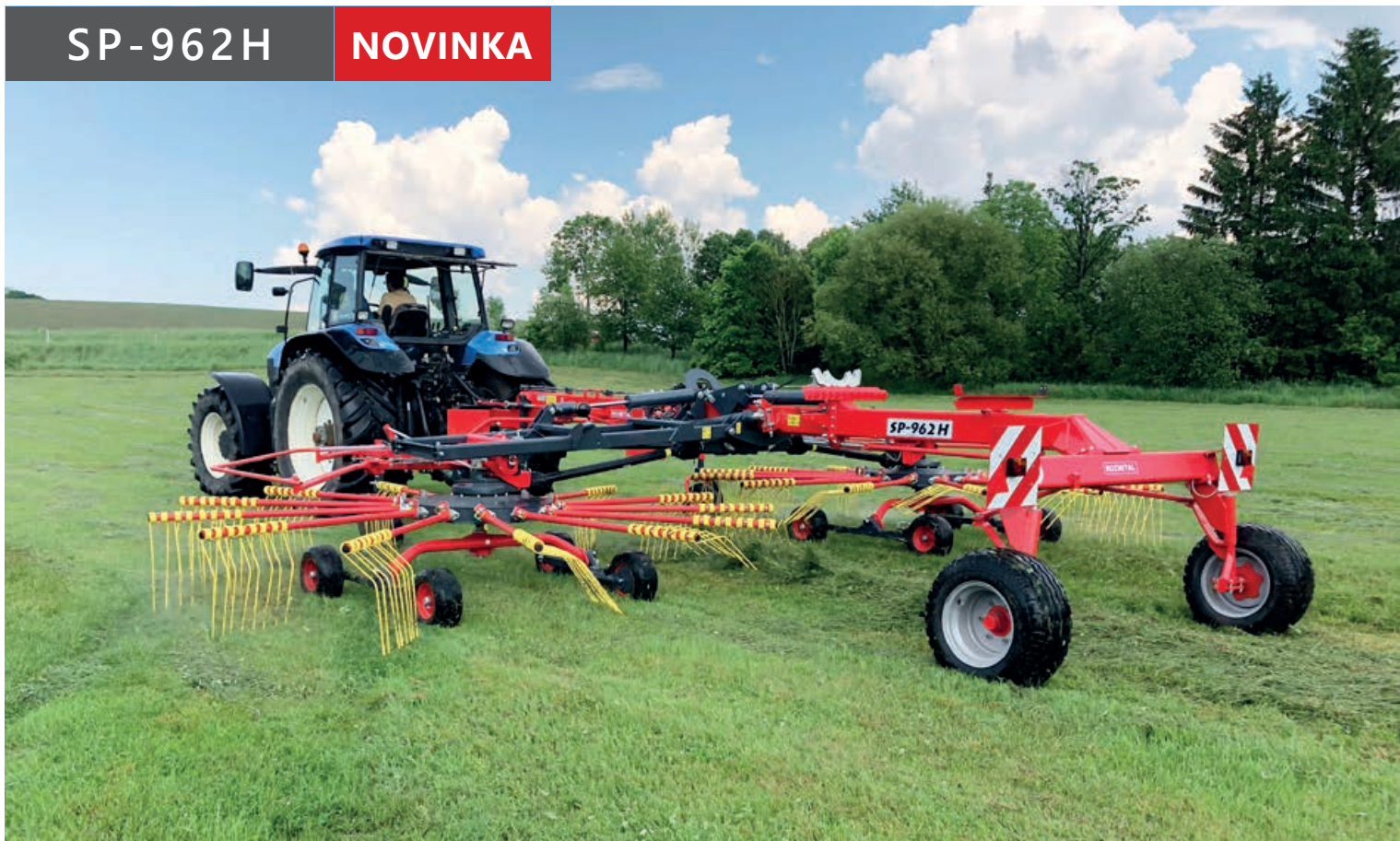
SP-962H dvourotorový shrnovač na prostřední řádek s hydraulicky nastavitelným záběrem Zámky hydraulického okruhu ve standardu
