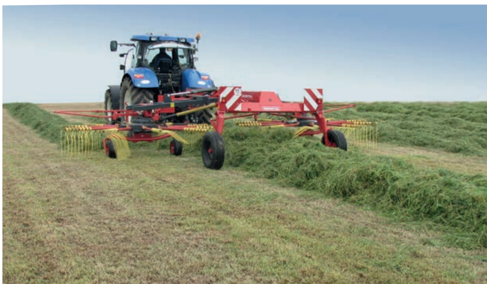
SP - 772D dvourotorový shrnovač na prostřední řádek se skokově nastavitelným pracovním záběrem
