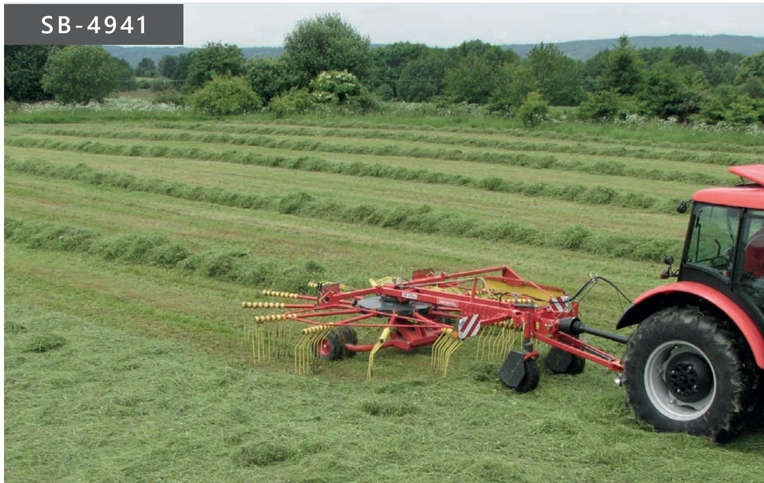
Pracovní záběr 4,90 m. Tažený stroj, dvojmontáž ve standardu
