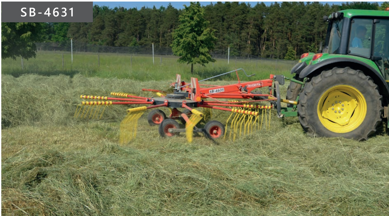
Pracovní záběr 4,60 m. Tandemový podvozek se 4 koly
