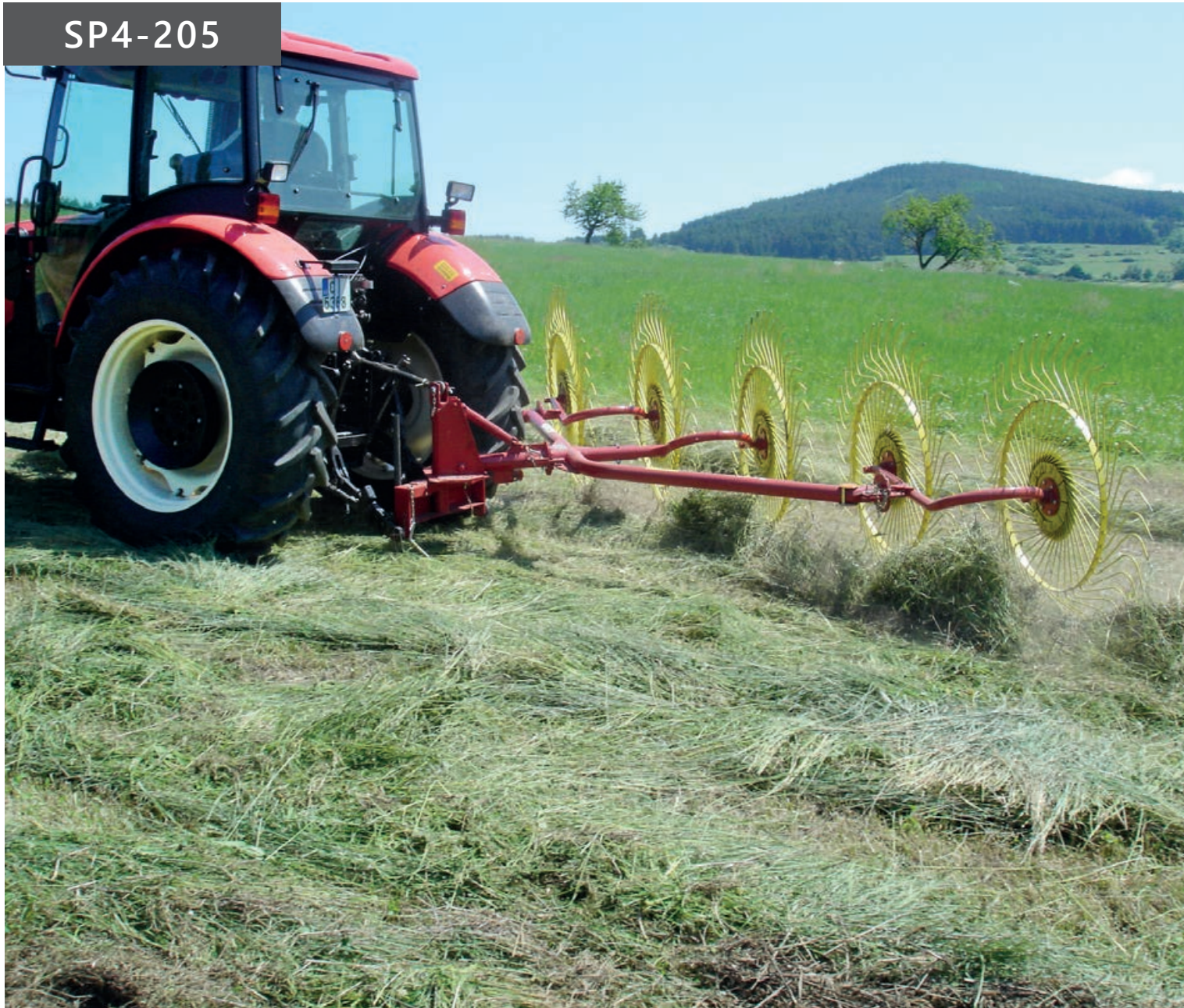
SP4-205 Univerzální obraceč a shrnovač v jednom stroji
