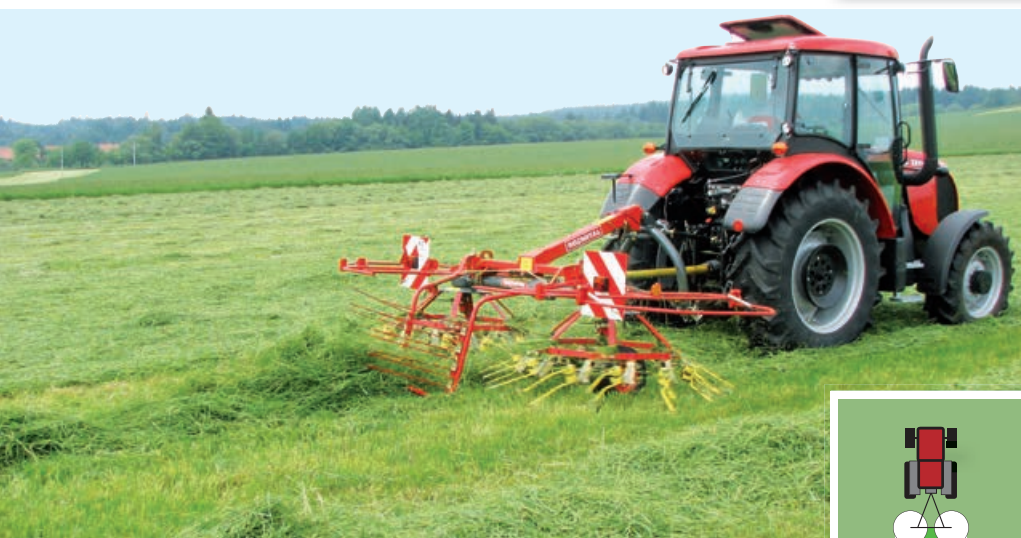
Shrnování - prutové stěny jsou v pracovní poloze
