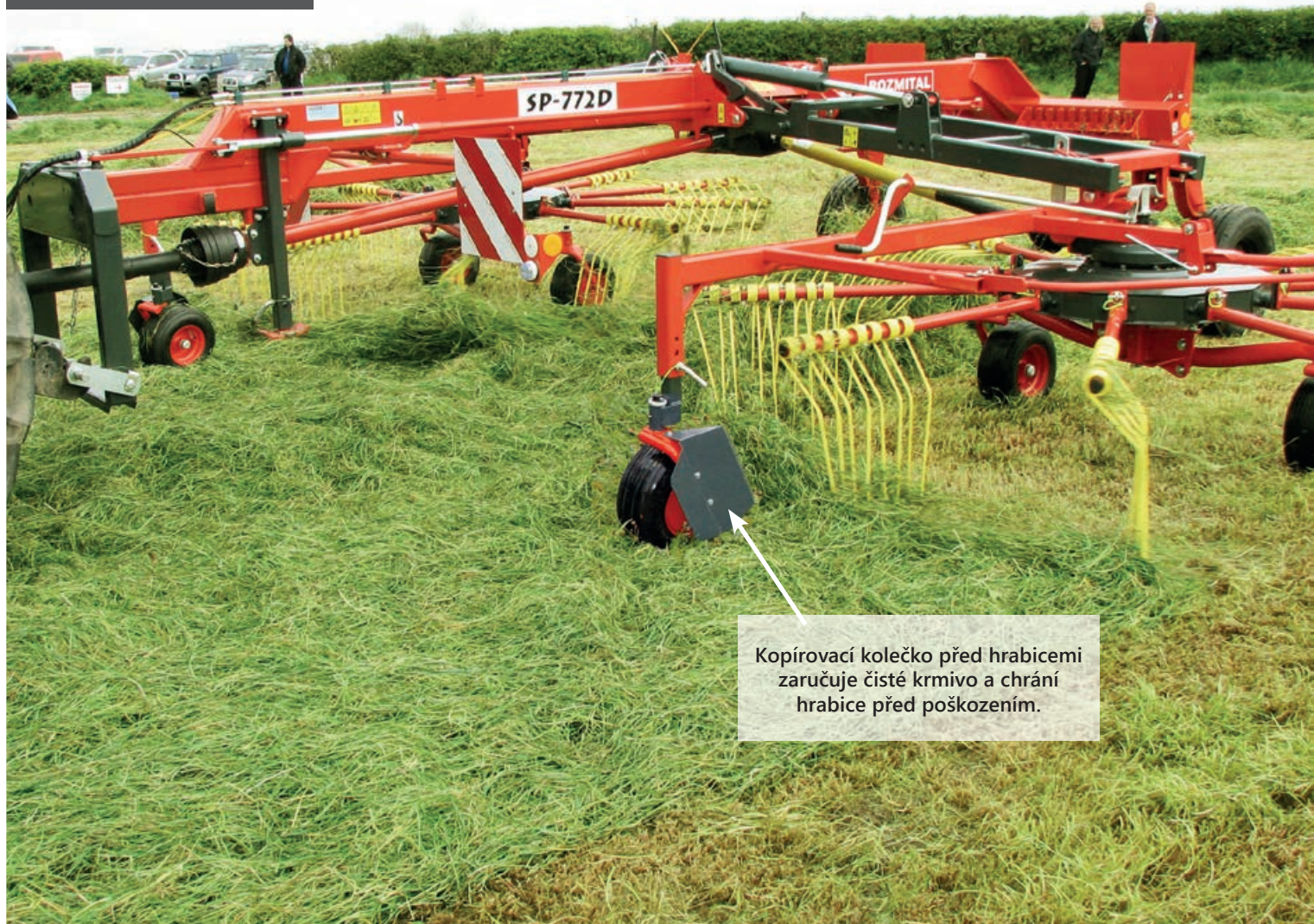
SP - 772D dvourotorový shrnovač na prostřední řádek se skokově nastavitelným pracovním záběrem
