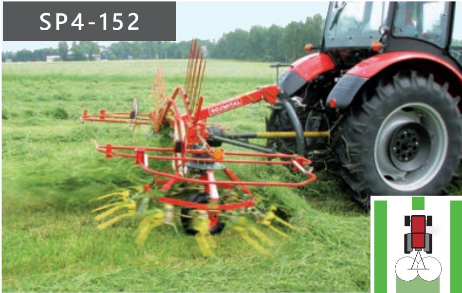
Wenden - die Rechenwände befinden sich in Transportposition
