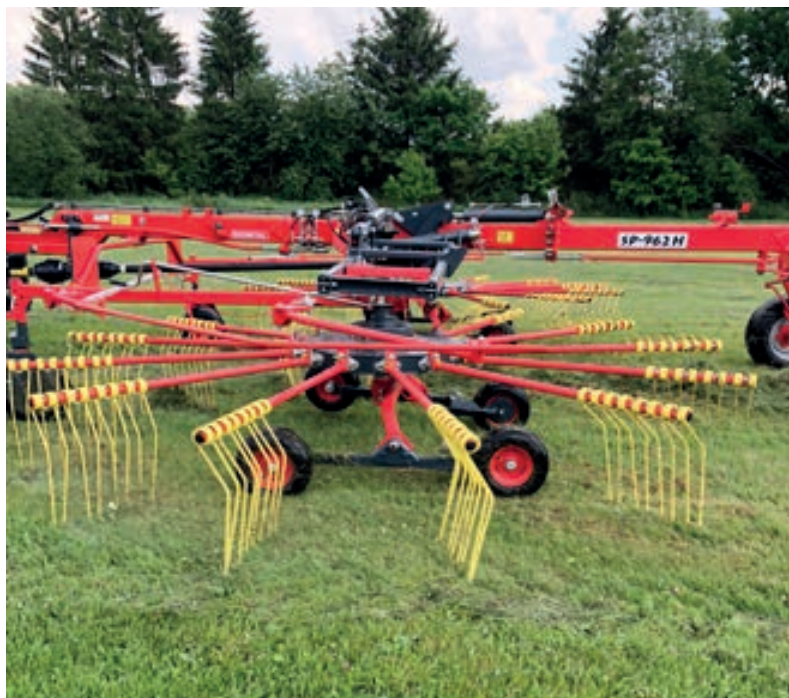
Rotoren mit 13 Armen und Durchmesser 4,2m. 4 Doppelzinken am Arm
