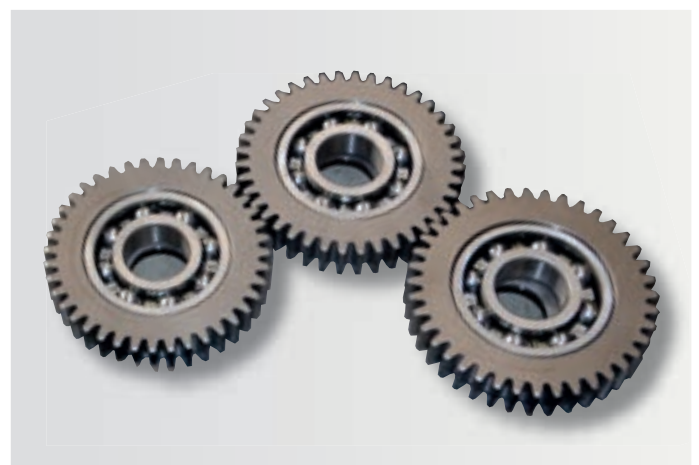
Die Zahnräder des Mähbalkens sind aus veredeltem Stahl geschmiedet und die Zahnseiten sind geschliffen. Die Zahnbreite beträgt 22 mm.
