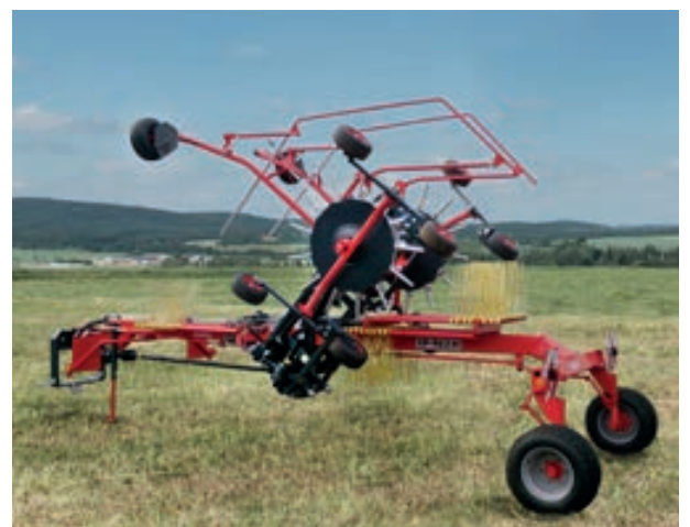
Rotoren mit 13 Armen und Durchmesser 4,2m. 4 Doppelzinken am Arm
